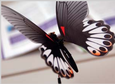
バイオメタルを利用したチョウチョロボットのサンプル品
