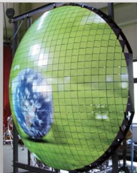
コンマ1ミリ精度で作った精密板金に有機ELパネルを、わずかにずらしながら継ぎ合わせて半球面形状を作った。構造設計と製作を担当。「CEATEC JAPAN 2011」における三菱電機のブースで、「半球面形状にしたオーロラビジョン」として展示され、来場者の注目を集めた。
